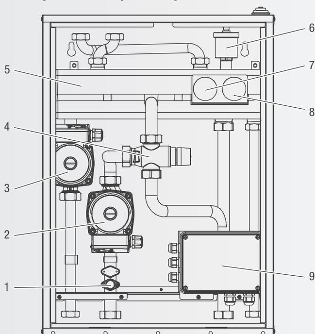
1. Termostato limite impianto bassa temperatura riarmo automatico
