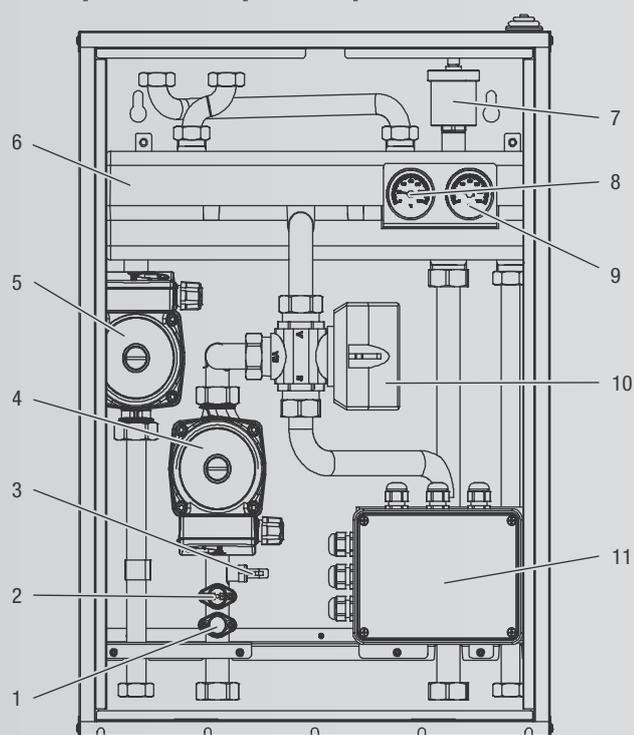
1. Termostato limite impianto bassa temperatura riarmo automatico
