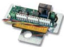
Avec l'utilisation de la nouvelle carte (au choix), il est possible de rattacher des pompes supplémentaires pour l'installation de plusieurs zones
