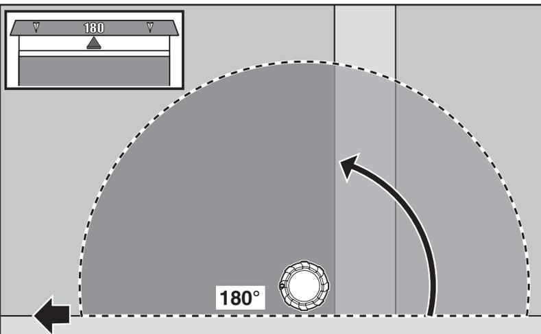
Il fermo sinistro indica il punto fisso o 0° dell'arco. L'angolo dell'arco determinerà il fermo destro dell'arco d'irrigazione.
