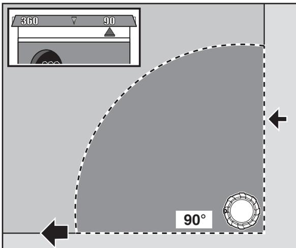
Allineare la freccia di arresto destra con il lato destro dell'arco di irrigazione.
