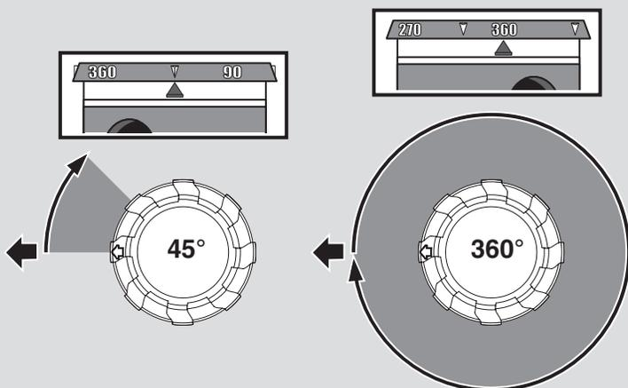
Usare la chiave in dotazione o un cacciavite per regolare il fermo destro dell'arco d'irrigazione. Ruotare in senso orario per aumentare, o in senso antiorario per diminuire.
