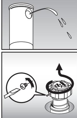
Per mantenere l'arresto di sinistra, allineare il montante con il corpo durante l'assemblaggio, come mostrato nell'illustrazione.
