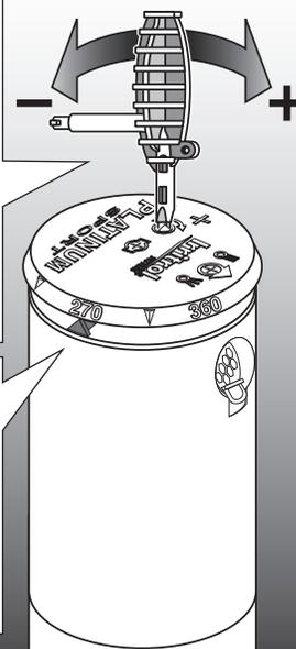
In sede di regolazione, osservare il movimento del puntatore dell'arco per indicare il preciso angolo dell'arco.
